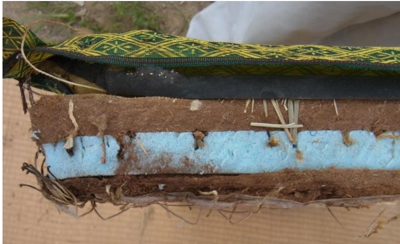
【断面図】ポリスチレンフォーム保温材を用いた化学畳
